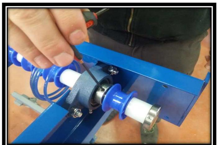
Mise en position de la vis pointeau et serrage à l'aide d'une clé Allen (BTR)
